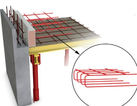
**7** Pose de 2 HA10 en nappe inférieure du chaînage de plancher
