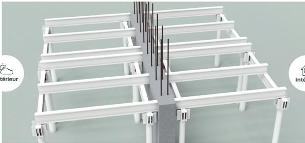
**2** Pose des nappes de treillis inférieures. Installation du capot h.
