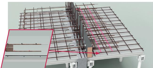
**8** Coulage de la dalle de balcon et de la tête de voile, puis coulage de la dalle de plancher.
