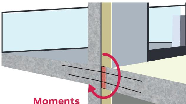
Au droit des rupteurs thermiques, comme pour tout appui de dalle, un moment de flexion s'exerce. Il est induit par **l'encastrement partiel** du plancher dans le voile.
