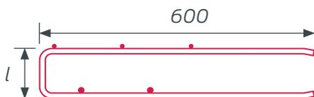
La mise en place du treillis supérieur forfaitaire est sans objet. Le ferrailage tient compte de la reprise du moment sur appui.
