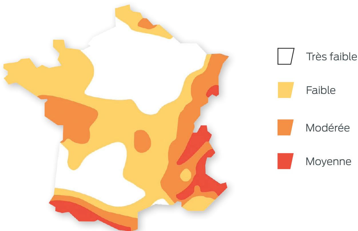
L'**Eurocode 8** (Calcul des structures pour leur résistance aux séismes) doit être appliqué en fonction de la situation géographique et la catégorie de l'ouvrage.
