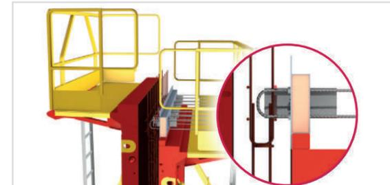
**4** Placer les valises et le lest. Couler le voile à l'arase de la languette haute du Slabe
